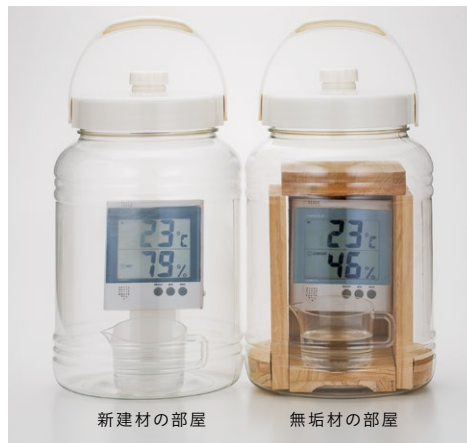
【新建材の部屋】 調湿作用がないため湿気で容器がぐもっている。
