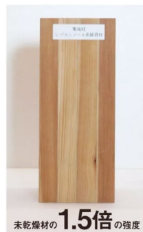
杉の柱(人工乾燥材) 未乾燥材の2.5倍の強度
