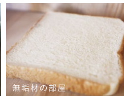
実験開始から4日目、新建材の食パンにはカビが斑点状に発生。6日目には全体に広がった。無垢材は14日経過してもカビの発生は確認できなかった。
