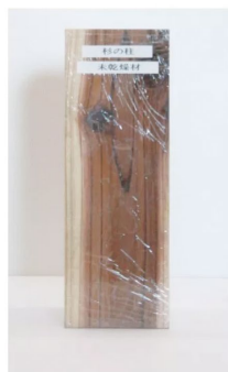
杉の柱(未乾燥材) (ラップを巻いて水分が高発しないようにしています)
