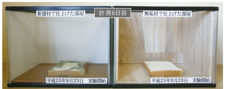
実験開始から4日目、新建材の食パンにはカビが斑点状に発生。6日目には全体に広がった。無垢材は14日経過してもカビの発生は確認できなかった。
